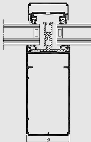
CR 120 est un système toiture de véranda à rupture de pont thermique.
