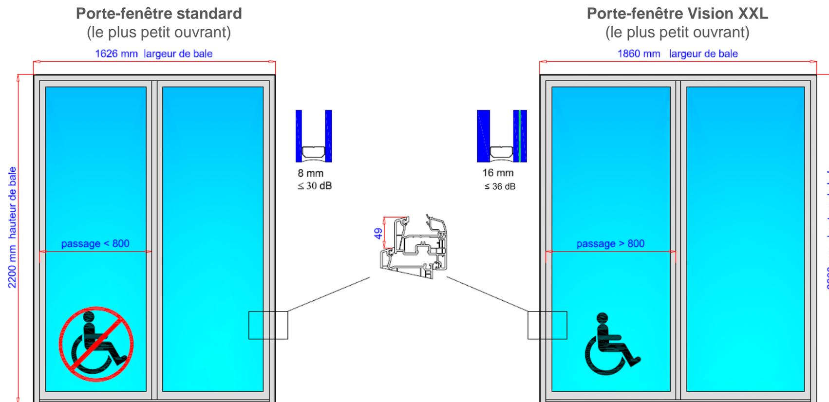
**Gagner en clair de vitrage** : pour une même dimension de menuiserie, l'ouvrant le plus fin de la gamme 70 mm VEKA remplace l'ouvrant porte-fenêtre serrure pour plus de clair de vitrage et un passage PMR préservé. C'est davantage de lumière et d'apports solaires en rénovation.
