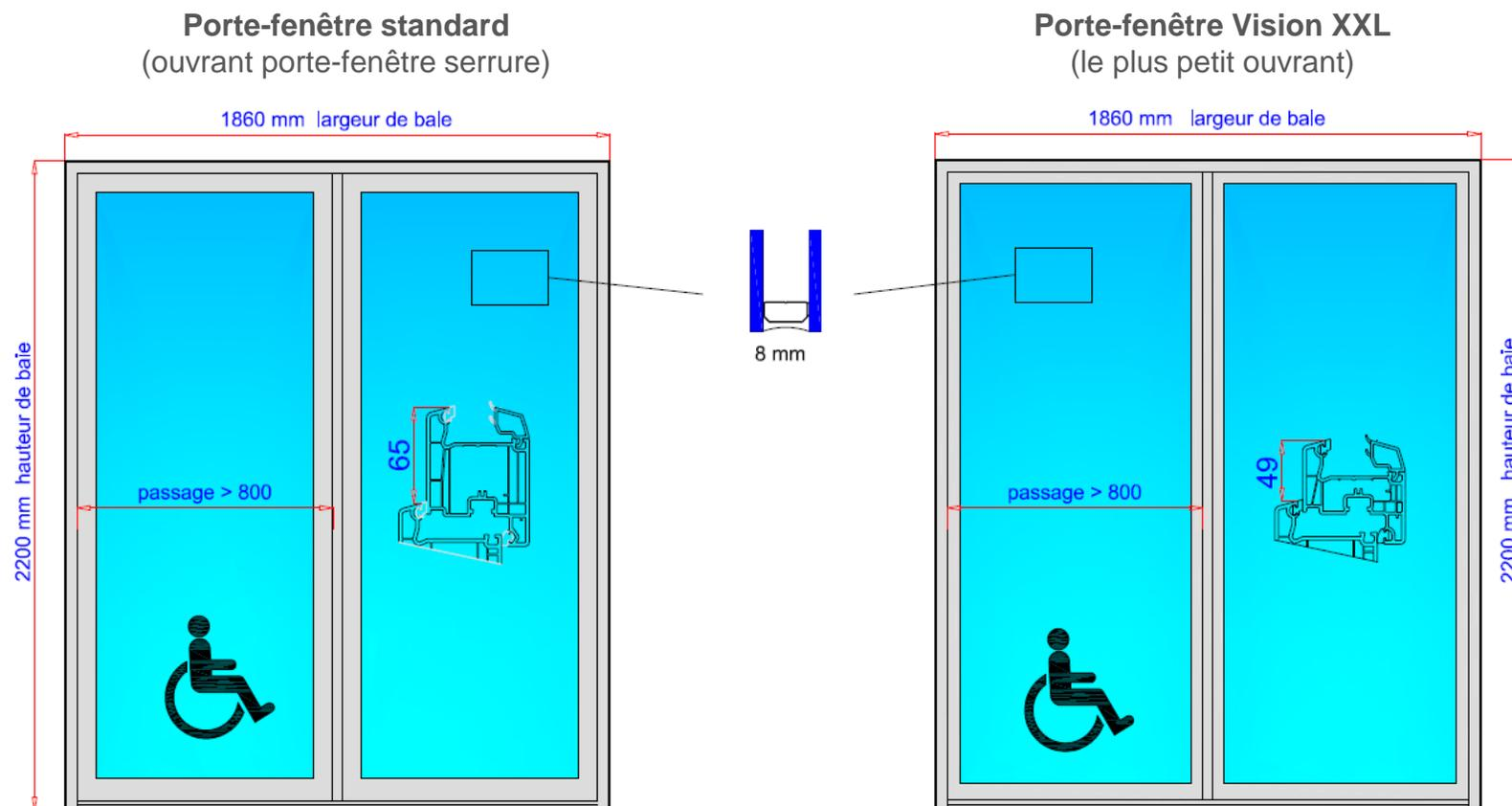
**Augmenter la charge de vitrage** : avec l'ouvrant le plus fin de la gamme 70 mm VEKA, la fenêtre à un vantail offre de plus grandes dimensions et de meilleures performances acoustiques avec une charge de vitrage plus importante.
