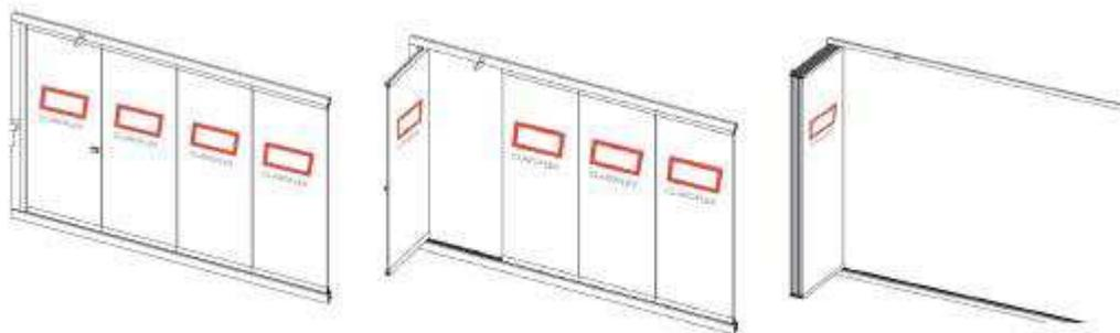
**Exemple de système de vitrage coulissant monté linéairement avec une porte mobile intermédiaire**
