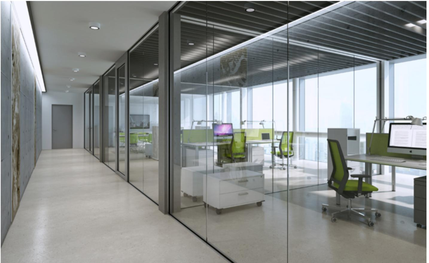
Aluprof propose également une version avec des profilés aménagés dans le plancher, les murs et le plafond. Une fixation « cachée » renforce l'effet optique d'agrandissement d'espace, tout en maintenant une protection incendie complète de la construction.
